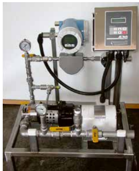
Дозирующее устройство ELF-SGP-D для ввода Rediset LQ в трубопровод подачи битума.
